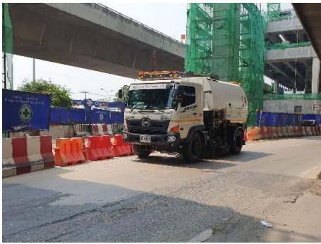
การใช้รถกวาดตูดฝุ่นทำความสะอาดถนนสาธารณะ บริเวณสถานี MT-01
